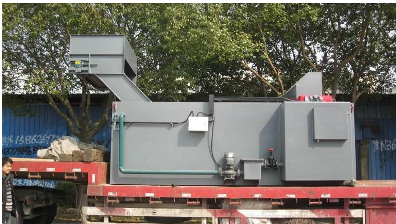
Gaszący zbiornik olejowy:
