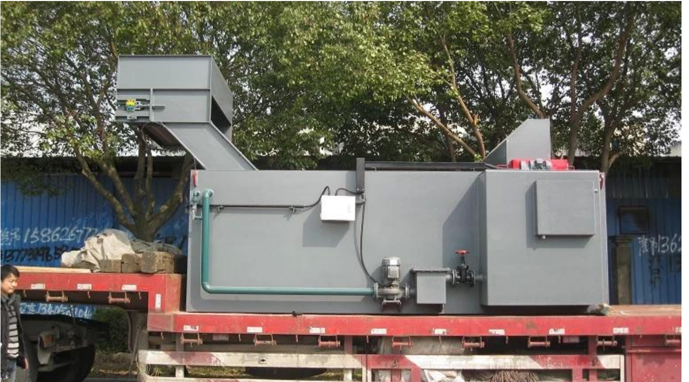
Yağ TANK söndürülmesi:
