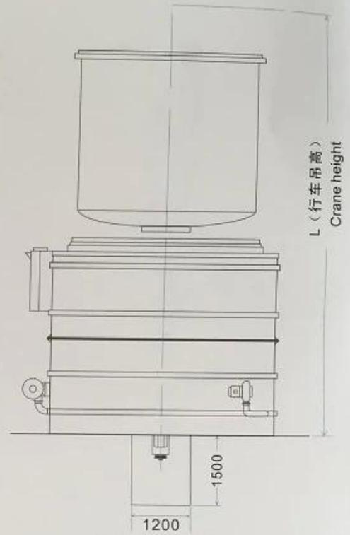
炉体安装吊高 (无脚架)
