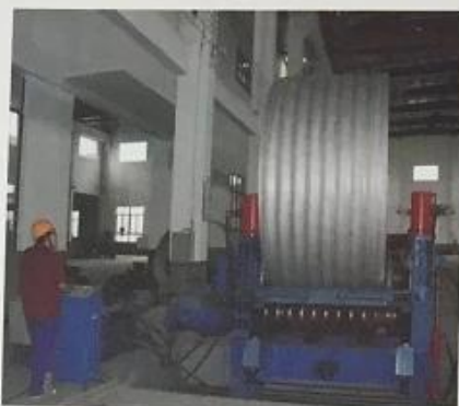
波纹桶成型 Corrugated molding
