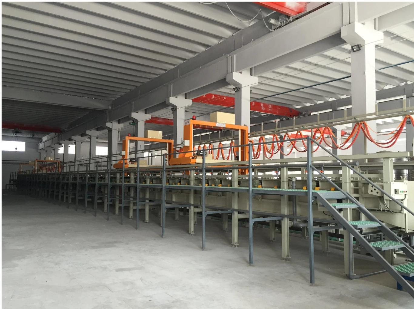
Бочка покрытие автоматической производственной линии может быть адаптирован к множеству мелких деталей, стандартных деталей и различных видов покрытий требует существенного увеличения производительности труда. Покрытие было предусмотрено, чтобы ожидать от отказа от полного набора воды и оборудования для сушки.
