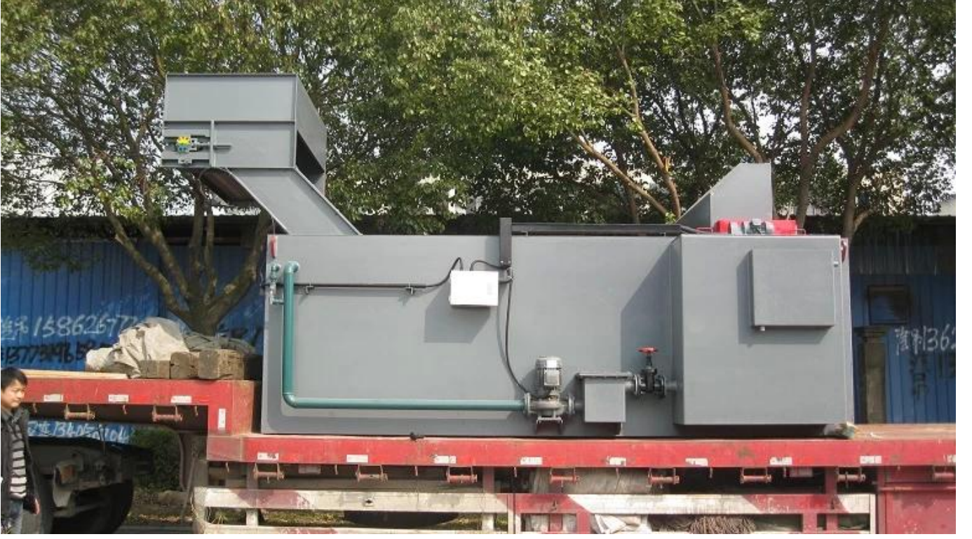
Yağ TANK söndürülmesi:
