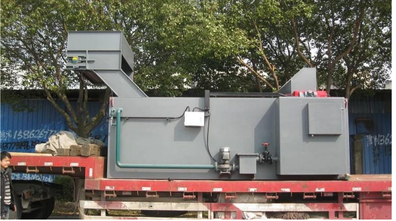
Yağ TANK söndürülmesi:
