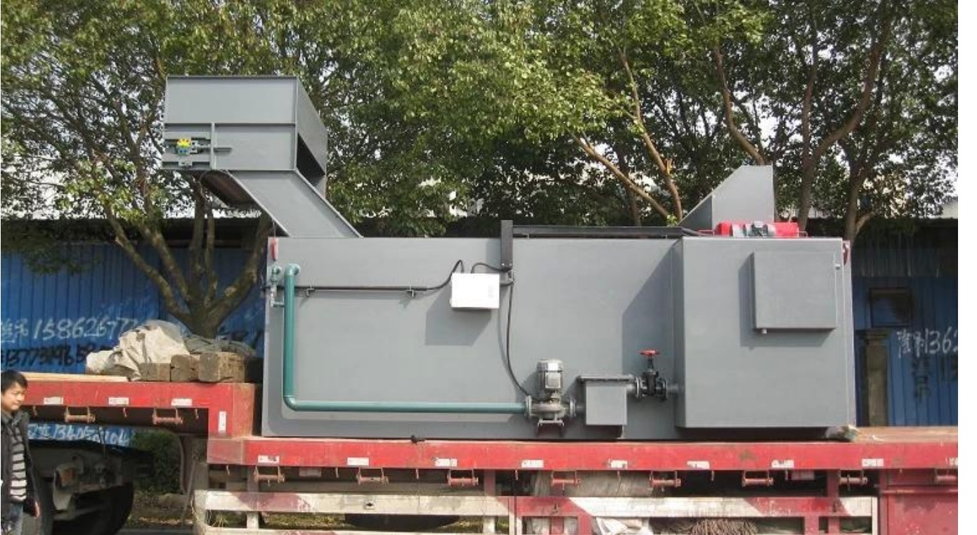
Yağ TANK söndürülmesi:
